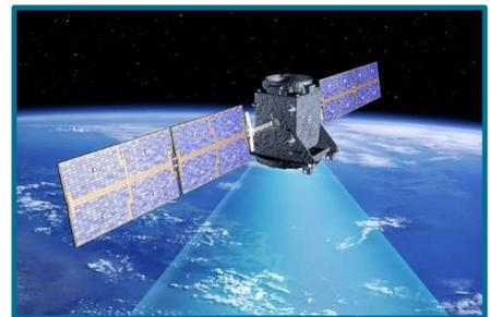
Ein GPS-System besteht aus mehreren Satelliten auf verschiedenen Umlaufbahnen. Der Abstand dieser GPS-Satelliten zur Erde beträgt ungefähr 20'000 Kilometer.
